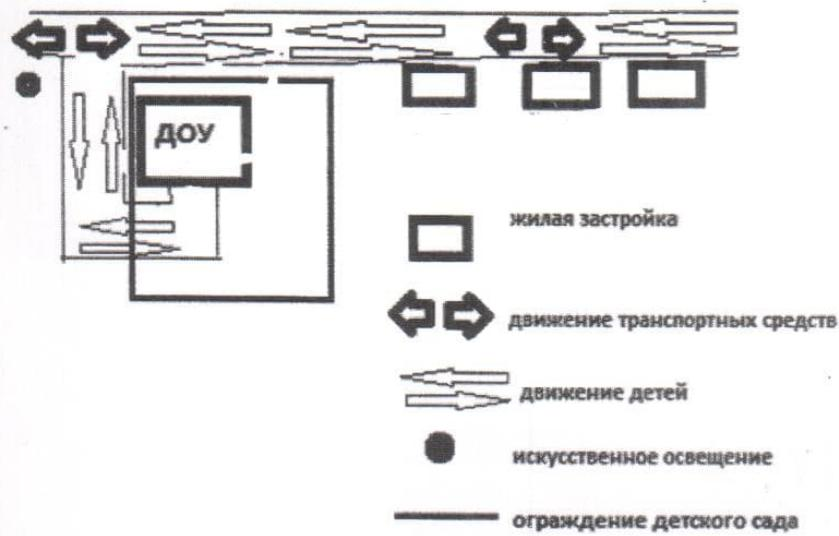
**Пути движения транспортных средств и места разгрузки/погрузки и рекомендуемые
